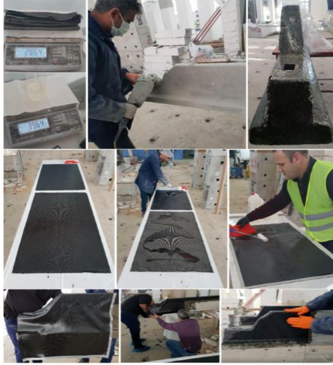
Şekil 3. Kompozit aşıkların oluşturulması
