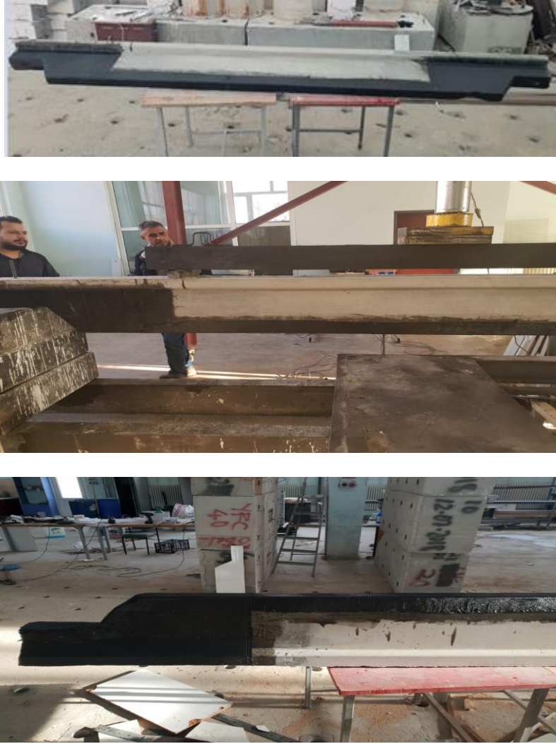
Şekil 2. Tam ve yarım sargılı numuneler
