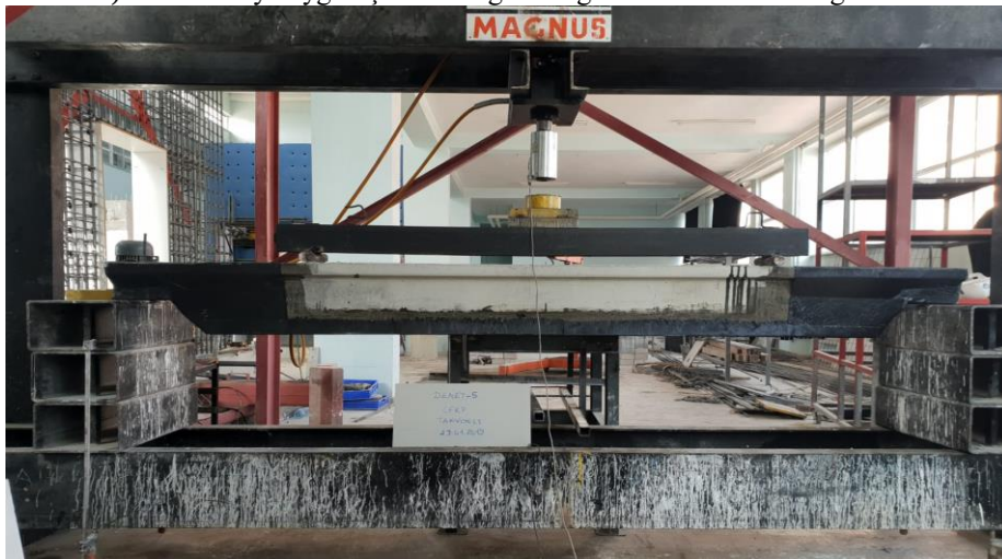
c) TS9967'ye uygun çekme bölgesi sargılı ve iki ucu tam sargılı numune
