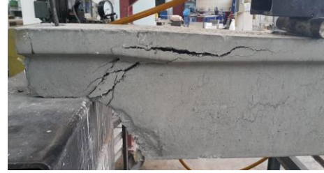
Şekil 9. TS9967'ye uygun numunelerin inceltilmiş uç bölgelerinde oluşan hasarlar
