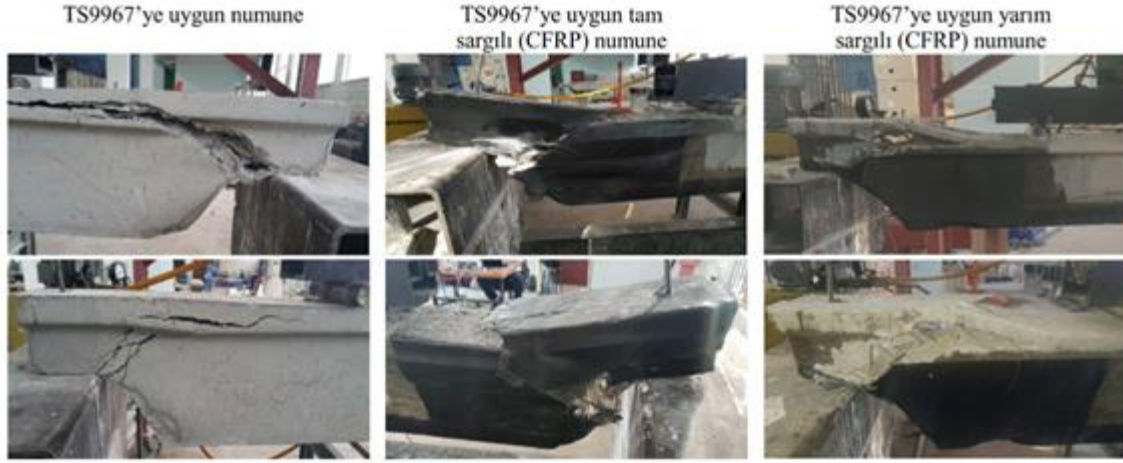
Şekil 5. İnceltilmiş uç bölgelerinde oluşan hasarlar
