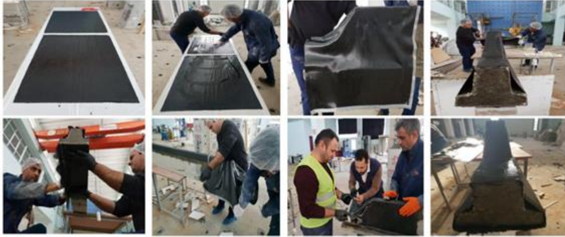
Şekil 1. CFRP numunesinin uygulama aşamaları
