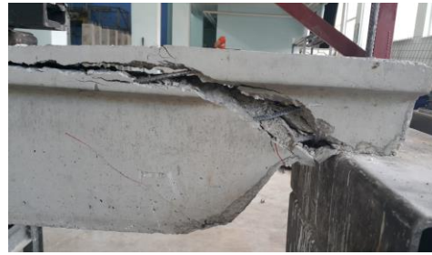
Şekil 10. TS9967'ye uygun olmayan numunelerin inceltilmiş uç bölgelerinde oluşan hasarlar
